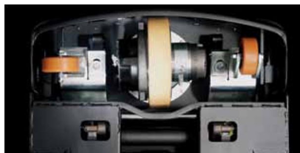
Optymalna stabilność i sterowność modelu LWE130 dzięki układowi jezdnemu z pięcioma kółkami oraz umieszczeniu kółek samonastawnych w obrębie obrysu korpusu wózka
