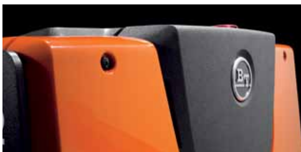
Umocowanie maski dwoma wkrętami umożliwia szybki dostęp
