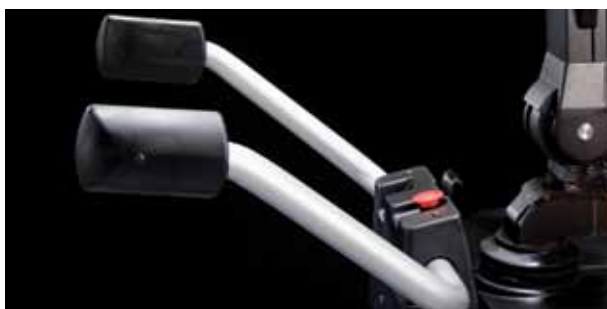
Przy zastosowaniu składanych osłon bocznych wózek LPE200 może poruszać się z maksymalną prędkością 8,5 km/godz.
