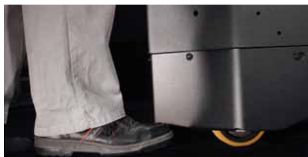
Osłona dolna podwozia w wózkach serii P zapewnia ochronę stóp operatora bez ograniczania łatwości poruszania się po pochyłościach i na zakrętach
