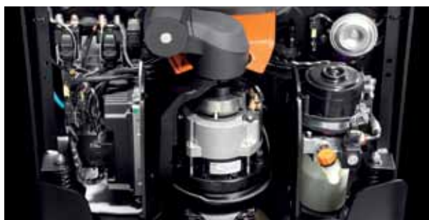
W nieruchomym silniku nie ma żadnych ruchomych przewodów
