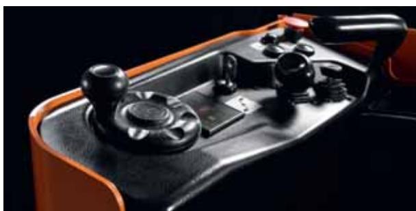
Obracana o 180° kierownica w serii LSE200 ułatwia kierowanie wózkiem
