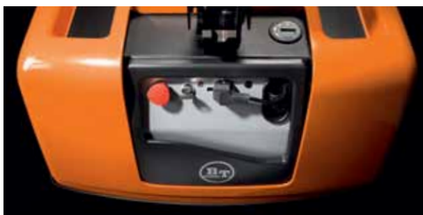
Łatwy dostęp do przycisku awaryjnego oraz przewodu wbudowanego prostownika
